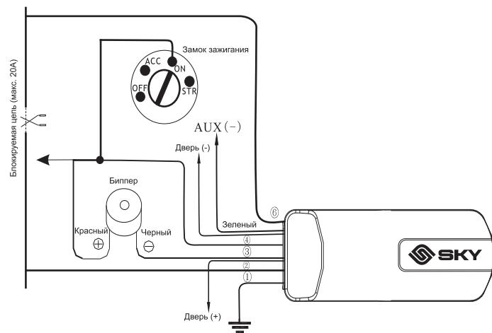
Зеленый провод: Служит для активации функции открытия замка капота при включении зажигания и подключается к активатору концевика капота. Появление минусового импульса активирует концевик
