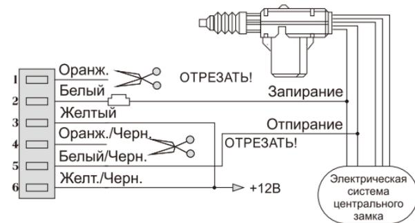
Примечание! Если автомобиль оснащен штатной системой Ц.З., определите сначала тип триггера: положительный или отрицательный
