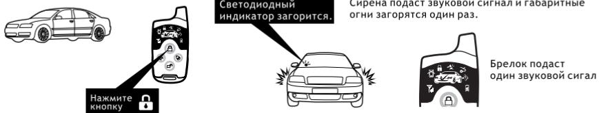
Для включения датчика объёма и удара нажмите кнопку
